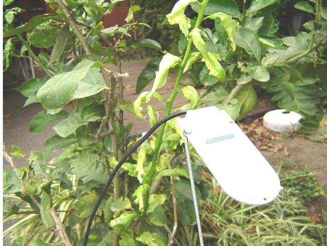
Nuestro sensor modelo SHM-1 funciona mediante la medición de la constante dieléctrica del agua contenida en la superficie superior del sensor.
